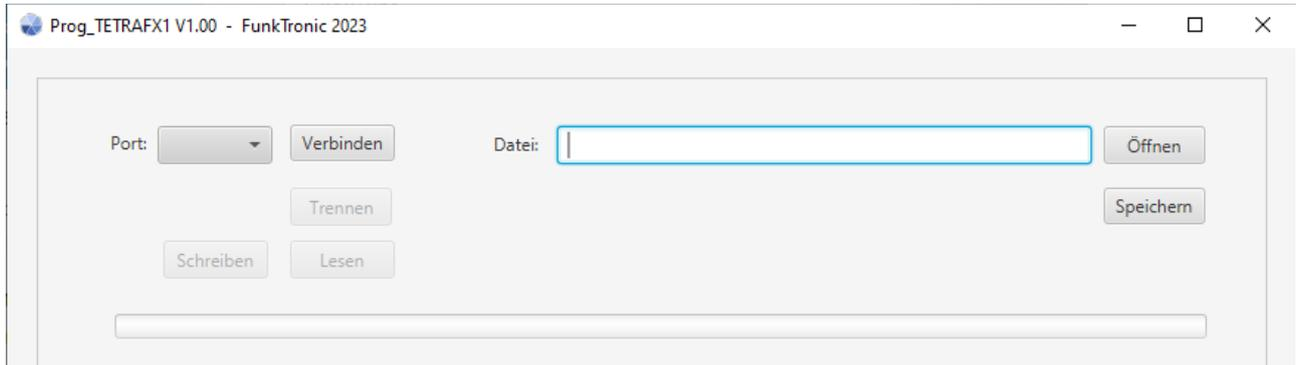
Wählen Sie den gewünschten COM-Port aus und verbinden Sie sich damit. Über die Schaltfläche "Lesen" können Sie die aktuelle Konfiguration auslesen und anzeigen lassen. Nach vorgenommenen Änderungen können Sie den neuen Stand über die Schaltfläche "Schreiben" wieder hochladen. Die Logikplatine startet daraufhin mit den neu gewählten Parametern.
