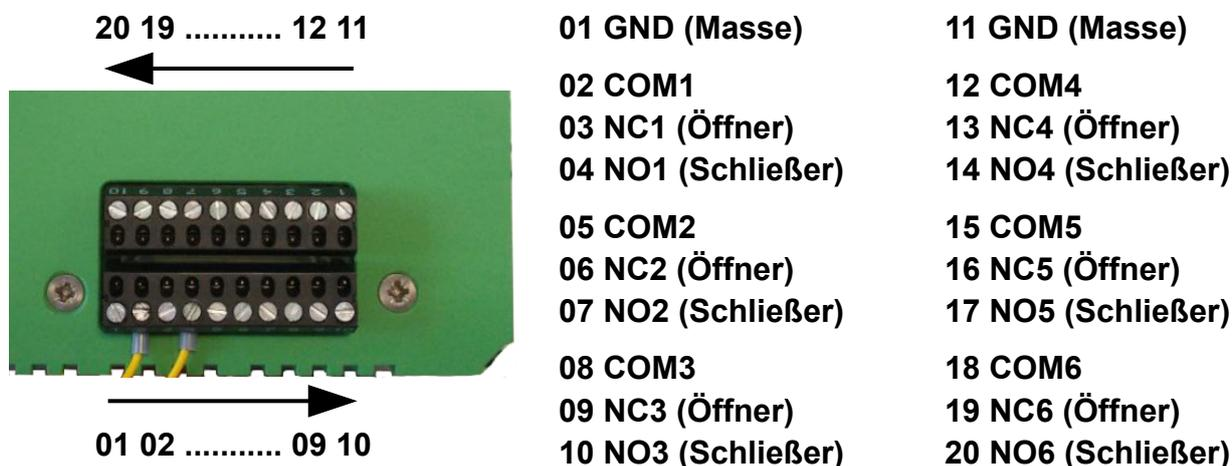
In den TSEs (Schaltschrankversionen) ist Relais-Ausgang 1 bereits ab Werk zum Sirenen-Relais durchverdrahtet und vorkonfiguriert, d.h. Klemme02 wird bei aktiver Sirenentastung auf Klemme04 durchgeschaltet.
