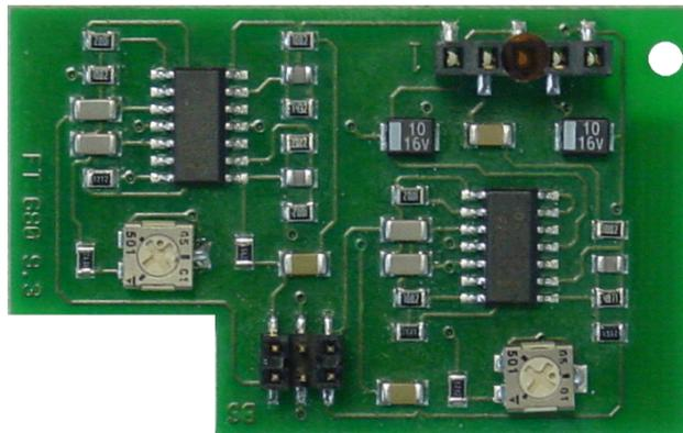
Notch-Filter zum Einbau in Funktronic Bediengeräte. Major 4a, 5a und Line-Interface LIM AC.
